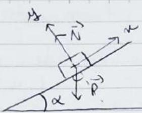
En l'absence de frottements: le poids  $\vec{P}$  et la réaction normale  $\vec{N}$ .
